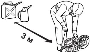
Осторожно обращайтесь с топливом, хорошо закрывайте крышки на баке пилы и канистре, перед запуском двигателя отойдите от места заправки не менее чем на 3 метра и убедитесь в отсутствии течи топлива через крышку топливного бака или в топливной системе.
