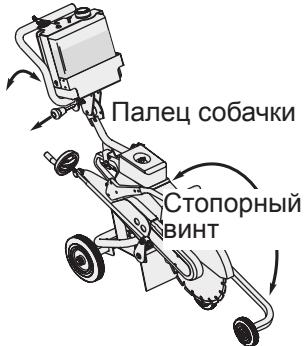
Для регулировки положения рукоятки, подайте палец кулачковой собачки наружу против направления давления пружины, поверните рукоятку, отпустите палец кулачковой собачки, чтобы зафиксировать рукоятку. Рукоятка имеет семь различных фиксированных положений.
