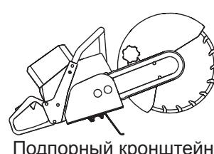
Чтобы использовать пилу вручную без тележки, открутите четыре гайки Nyloc M8 внизу, расфиксируйте защелку и поднимите пилу.
