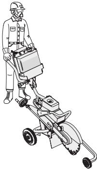
Крепко держите тележку обеими руками при работающем двигателе. Все пальцы должны плотно и надёжно охватывать рукоятки. Это поможет сохранить контроль над бензорезом при отдаче или если вращающийся диск «тянет» от оператора. Запрещено держать работающий инструмент одной рукой.
