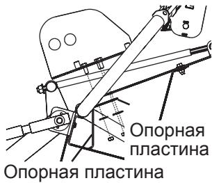
Снимите установочную пластину пилы, открутите четыре гайки Nyloc M8 и снимите плоские шайбы (ключ 13 мм).
