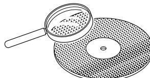
Перед использованием внимательно осматривайте диск на отсутствие трещин, повреждений кромки и деформации.
